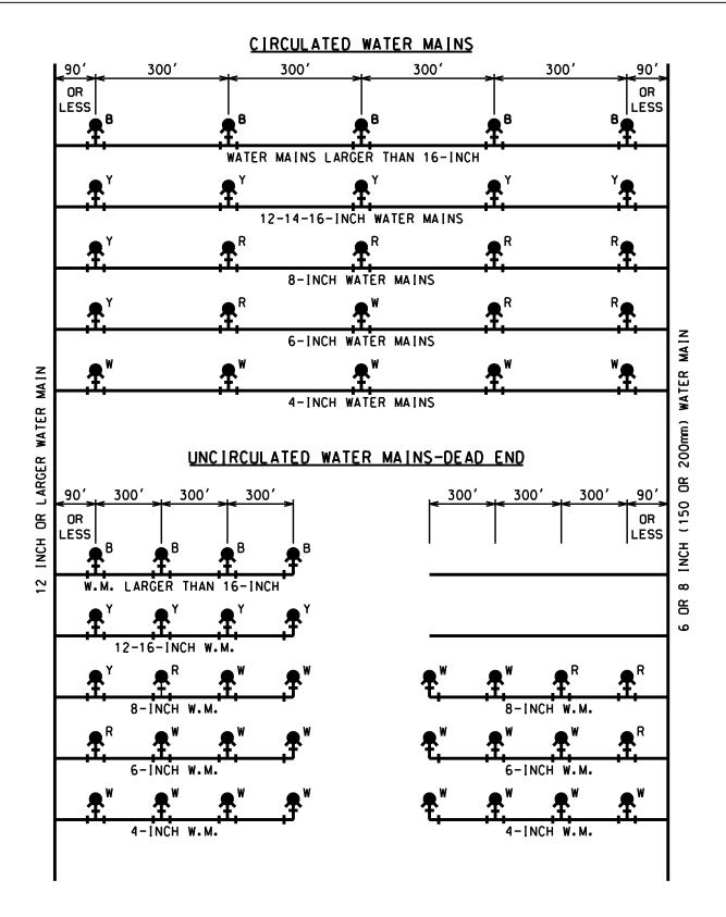
B-BLUE FLANGE Y-YELLOW FLANGE R-RED FLANGE W-WHITE FLANGE ALL PUBLIC FIRE HYDRANTS ARE TO BE PAINTED RED EXCEPT FOR THE TOP FLANGES WHICH MUST BE COLOR CODED.
